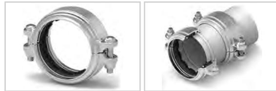
마운트식 접합방식: 파이프에 돌기형 마운트를 형성하여 파이프의 이탈을 방지하고 체크기능을 가지는 특수주조의 고무패킹에 의해 수밀을 유지 접합하는 방식으로, 그루브 방식을 적용할 수 없는 일반 배관용 스테인리스강관에 사용되어 기존 홈 조인트보다 체결력을 크게 높인 내진조인트.
